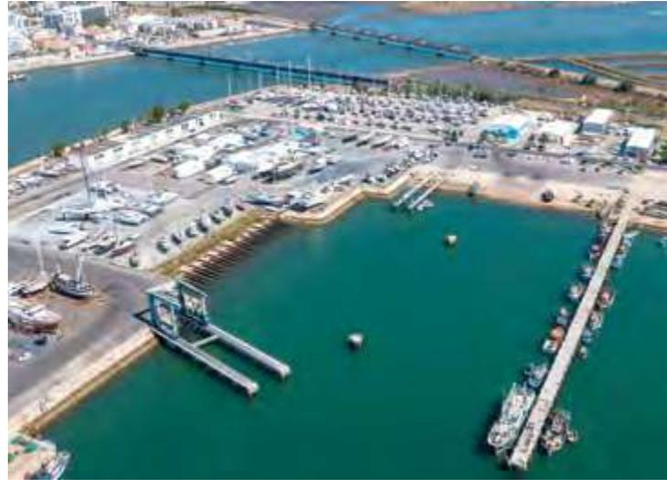
A entrada de vaga em dias de tempestade afeta a estabilidade dos pontões e o conforto dos utilizadores. A transição de quebra-mares flutuantes para estruturas fixas permitirá melhorar a segurança e receber embarcações de maior calado.
